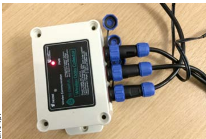
↑ Element instalacji czujnika pozwalającego na monitorowanie przepływu, ciśnienia i temperatury wody w gospodarstwach domowych
